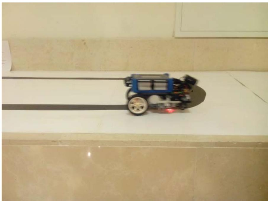
In conclusione, la piattaforma myRSD offre agli sperimentatori una soluzione completa (hardware e software) per il controllo di robot didattici realizzati con LEGO Mindstorm. La piattaforma è costituita da una scheda d'interfaccia d'interconnessione tra l'ecosistema LEGO Mindstorm ed il potente PC-Embedded myRIO e dalle necessarie librerie software, per la programmazione in LabView del myRIO stesso.
